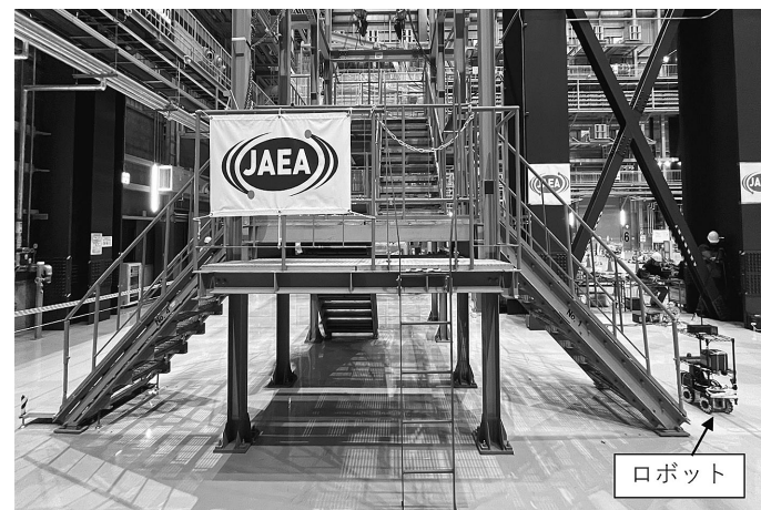
カメラやLiDAR(ライダー)等のセンサーを利用し、ロボットの進む先の電波強度を予測、通信切断を防ぐ。福島第1原発モックアップで実験を行った
