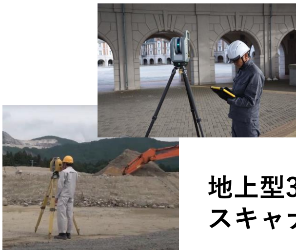
測量機 (自動視準・自動追尾機能付き 高機能トータルステーション)
