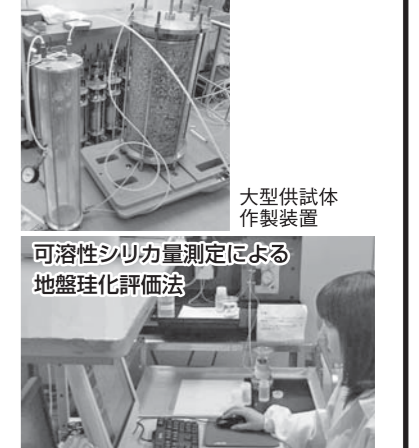
写真6 ICP分析による地盤珪化評価法(強化土エンジニアリング(株) 日本化学工業(株) 共同開発)
