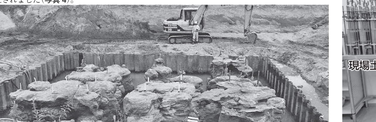
写真1 1999年産学協同研究による大規模野外注入試験(株)ADEKA鹿島工場敷地(神奈川県) 参考著書1)米倉・島田:薬液注入の長期耐久性と恒久グラウト本設注入工法的设计施工,近代科学社,2016.10 2)東畑・米倉・島田・社本:「地震と地盤の液状化-恒久・本設注入によるその対策」,インデックス出版,2010.10 3)恒久グラウト・本設注入協会:恒久グラウト注入工法技術マニュアル,2017改訂版 4)「恒久グラウトと注入技術」平成14年度(公社)地盤工学会技術開発賞関連技術・付東北地方太平洋沖地震における施工地盤の追跡調査報告書,2014.10改訂版 5)その他:学会論文、報文多数
