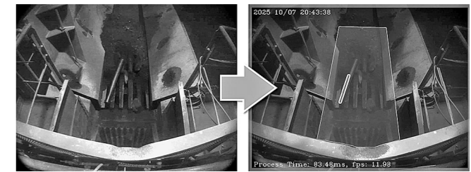
鋼管混入検知の例
