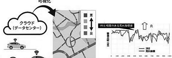
車輪の回転速度から路面状況を分析・地図にプロット
