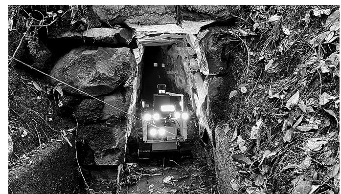
狭隘・泥濘環境下の水路を点検するクローラ型ロボット
