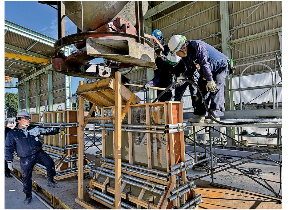
高流動コンクリの普及に向け共同研究を行っている。写真は供試体の作成状況(土研研究所提供)
