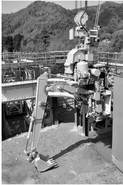
自動化オープンケーソン工法概要図と水中掘削機
