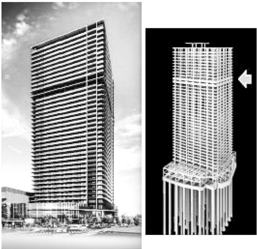
ジオタワー大阪十三の完成予想イメージと構造モデル
