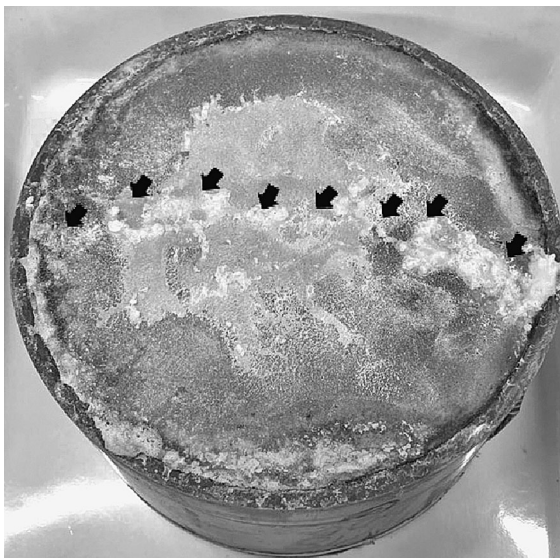
バイオスマートコンクリートの止水効果確認実験結果 左からひび割れ幅0.30mm(測定材齢5週で止水)、0.28mm(測定材齢6週で止水)
