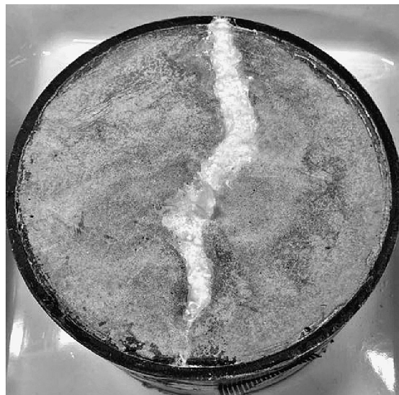
バイオスマートコンクリートの止水効果確認実験結果 左からひび割れ幅0.30mm(測定材齢5週で止水)、0.28mm(測定材齢6週で止水)
