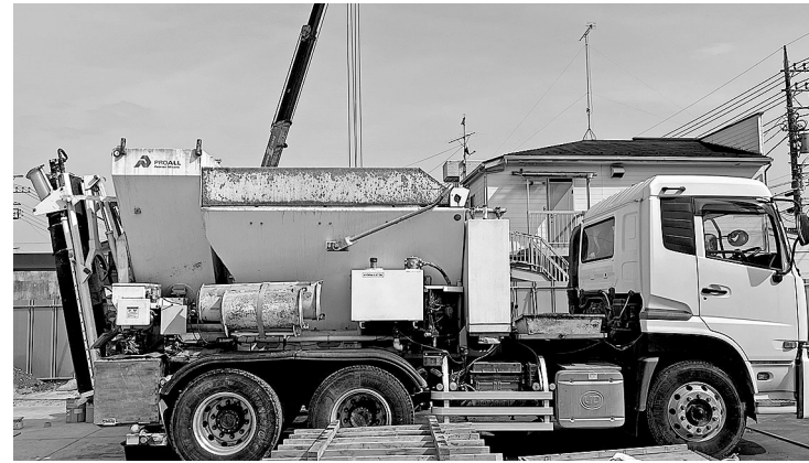
連続式モバイルコンクリートミキサー車
