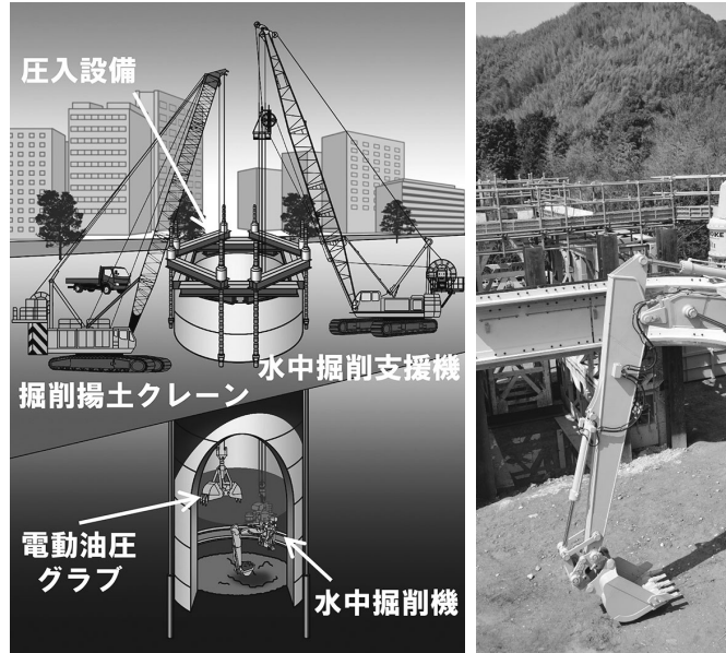
自動化オープンケーソン工法概要図④と水中掘削機
