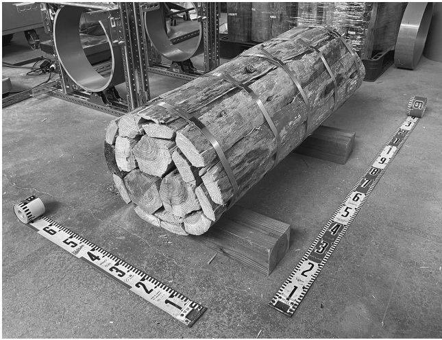
液状化対策に用いる木質コラム
