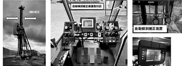
自動鉛直補正システム
