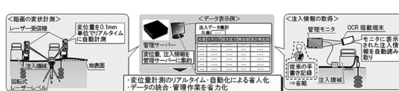
地盤変位量と注入情報を連携し管理する
