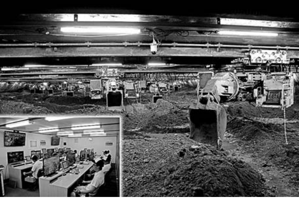
DREAM掘削機(遠隔操作型)
