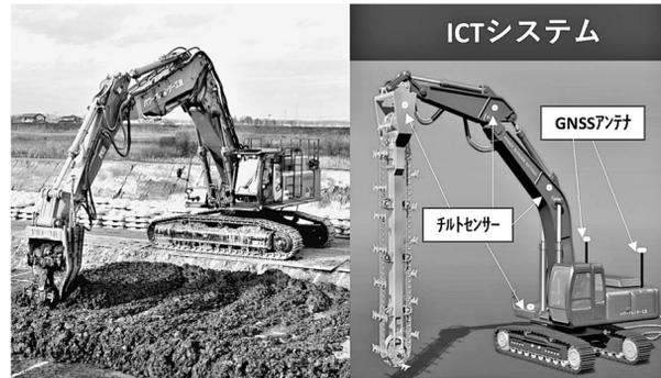
パワーブレンダー工法は、原位置土とセメント系固化材などの改良材をトレンチャ式攪拌混合機にて、望ましい流動値で鉛直方向に攪拌混合しながら、水平に連続掘進させる事により、互層地盤であっても改良範囲全域において均質な改良体の造成を可能とする地盤改良工法です。
