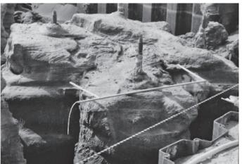
写真6 柱状浸透注入工法・エキスパッカ工法による低炭素グラウト「ハイブリッドシリカ」の高強度柱状連続固結体
