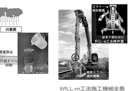
WILL-m工法施工機械全景
