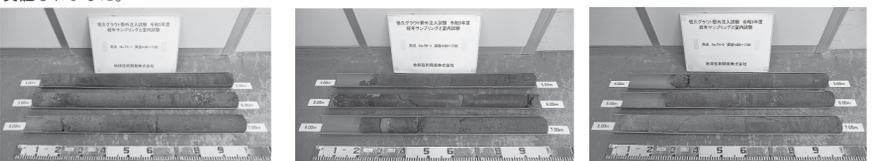
写真2 パーマロック(経年24年) 写真3 ハイブリッドシリカ(経年24年) 写真4 シリカゾルグラウト(経年24年)
