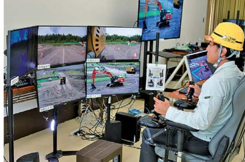
関東整備局が北麓(群馬県側)と南麓(長野県側)隔年で遠隔施工の講習会を行っている
