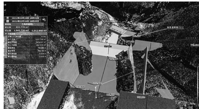
レーザー測量から土工事範囲の3D化
