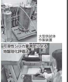
写真6 ICP分析による地盤珪化評価法 (強化土エンジニアリング(株) 日本化学工業(株) 共同開発)
