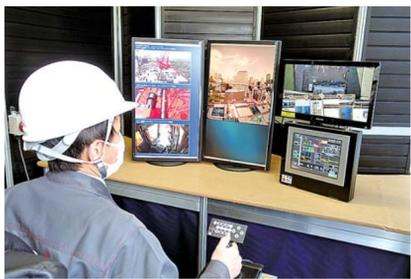
鹿島、竹中工務店が開発したタワークレーン遠隔操作システム
