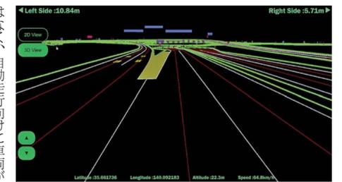
車両に提供する高精度3D地図データ。車線などの位置情報で自動走行を支える(ダイナミックマップ基盤提供)
