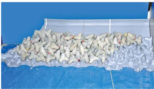
2019年1〜6月に施工した神奈川県東三河郡小田原市木下町の「平成30年度海岸高潮防波堤」の測量現場。ドローンで撮影した画像を点群データに処理し、3Dプリンターで模型化した。3D模型の縮尺に合わせて消波ブロックの配置位置や配置個数、クレーンの作業半径などを割り出した。施工計画の精度が格段に向上し、発注者への提案や協議が円滑に進んだという。
