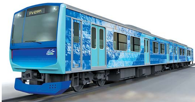
水素を利用した試験車両「HYBAR」のイメージ(JR東日本の報道発表資料から)
