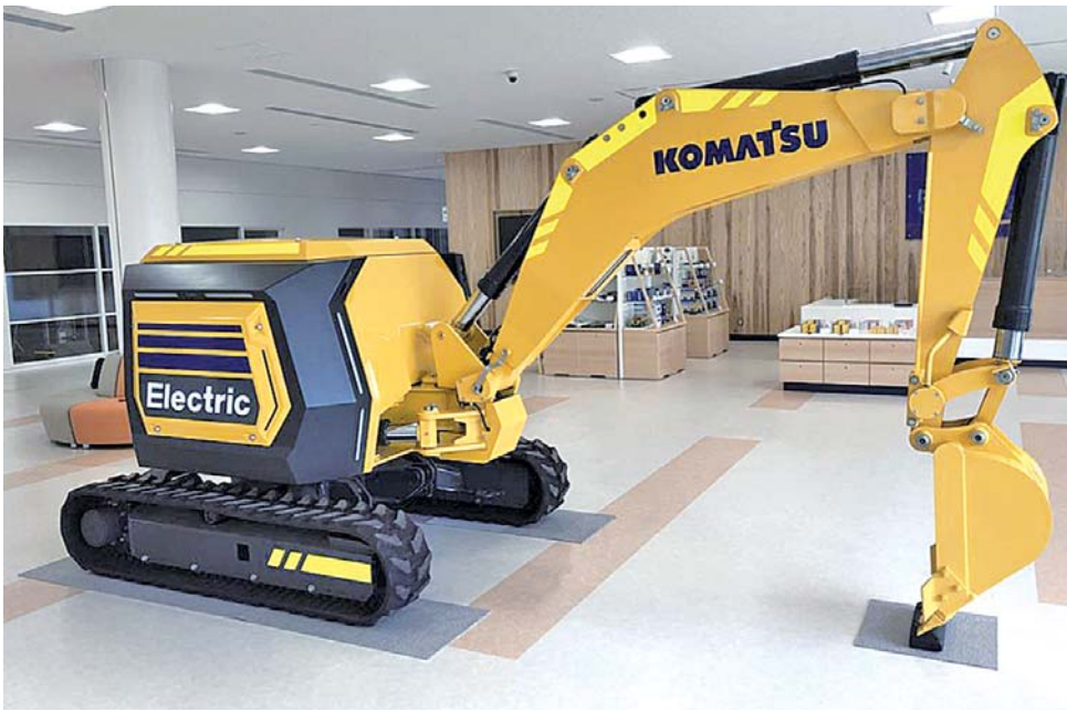
コマツが発表した次世代コンセプトマシンのフル電動ミニショベル(報道発表資料から)
