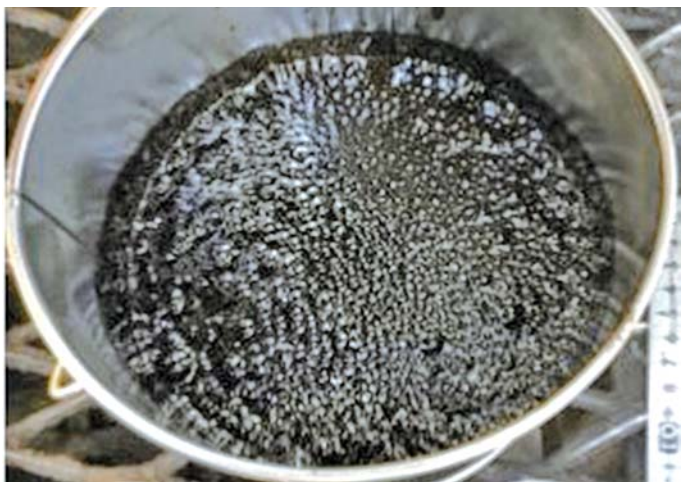
フォームドアスファルト発泡状況（NIPPO提供）
