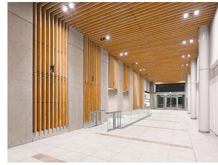
天井・壁面のルーバーに産産カラツ集成材を使用したエントランスホール
