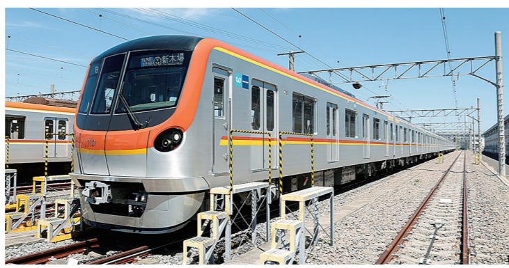
17000系一有楽町線・副都心線の新型車両。バリアフリー、空間性・快適性に優れ、安心感ある車内のほか、車両情報監視・分析システム(TIMA)の導入により安全・安定性を向上させ「沿線のお客様さまに末永く親しまれる快適な車両」をコンセプトにデザイン。2021年2月に営業運転を開始。
