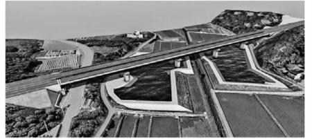
図1：3D地形モデルに橋梁3Dモデルを統合
