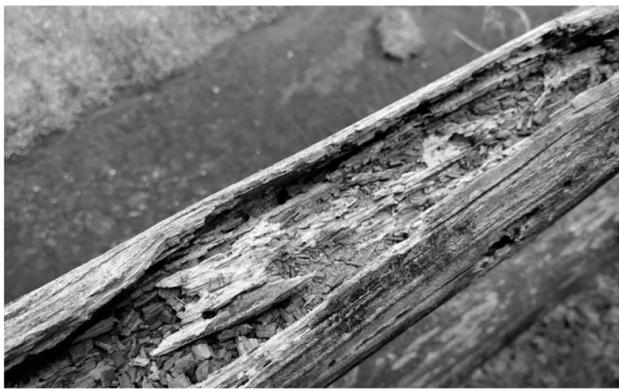
白色腐朽菌によって腐朽した木材
