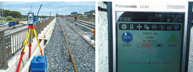
自動追尾トータルステーション②。測量結果は瞬時にスマホへ送信される
