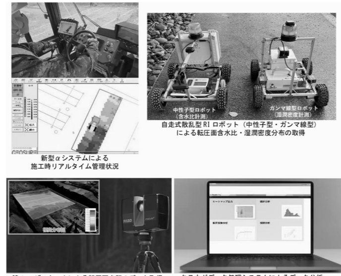
3Dレーザースキャナによる転圧面点群データの取得 クラウドデータ処理システムによるデータ分析
