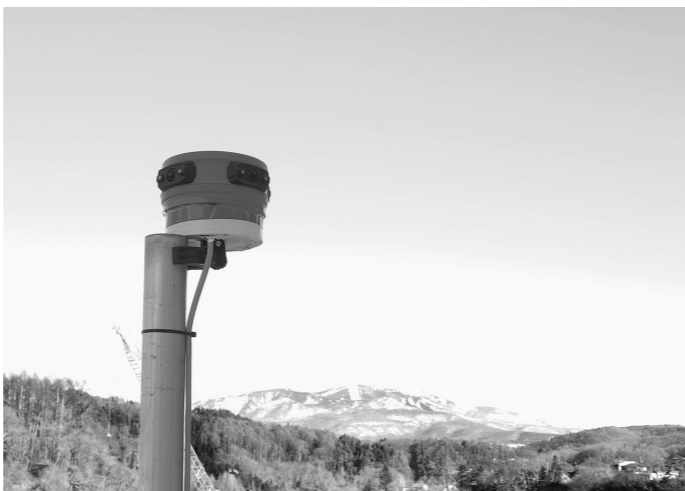
高感度PTZ対応ネットワークカメラ「AXIS P5655-E」。上下左右の首振りとズーム機能で現場内の見たいところをクローズアップできる
