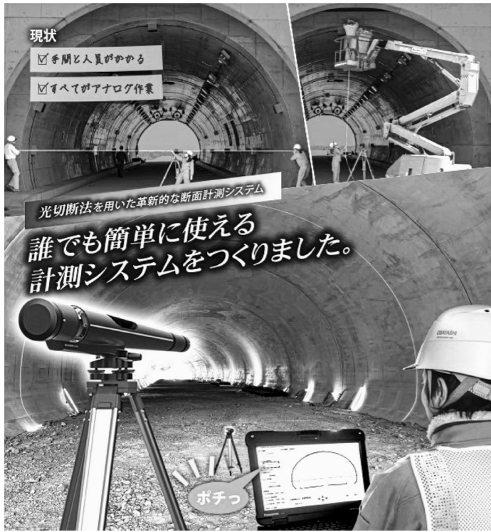
開発中の断面計測システム
