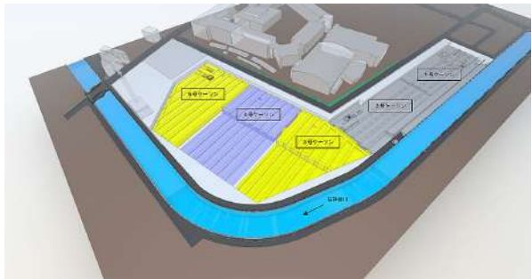
調節池3D(黄色が二期工事で設置)
