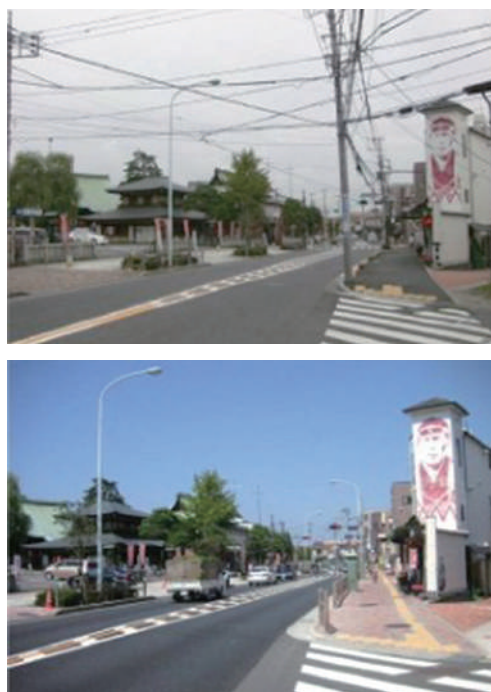
無電柱化の実施事例(整備前④と整備後)
