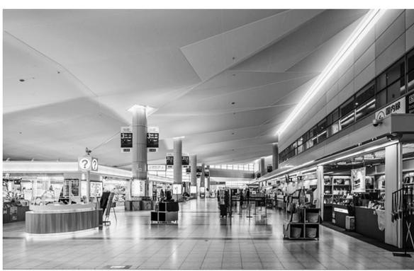
広島空港既存出発ロビー天井(特定天井該当部分)の耐震改修工事として計画。膜を使用した天井材により軽量化を図り、震災時の安全性を確保している。広島を象徴する平和への祈りを表現するため、折鶴をモチーフとした天井デザインとした。自然の光に近い光の変化に合わせた、季節、時間帯によって自動的に調光・調色を行う照明システムを採用し、快適さと環境負荷低減を両立している。
