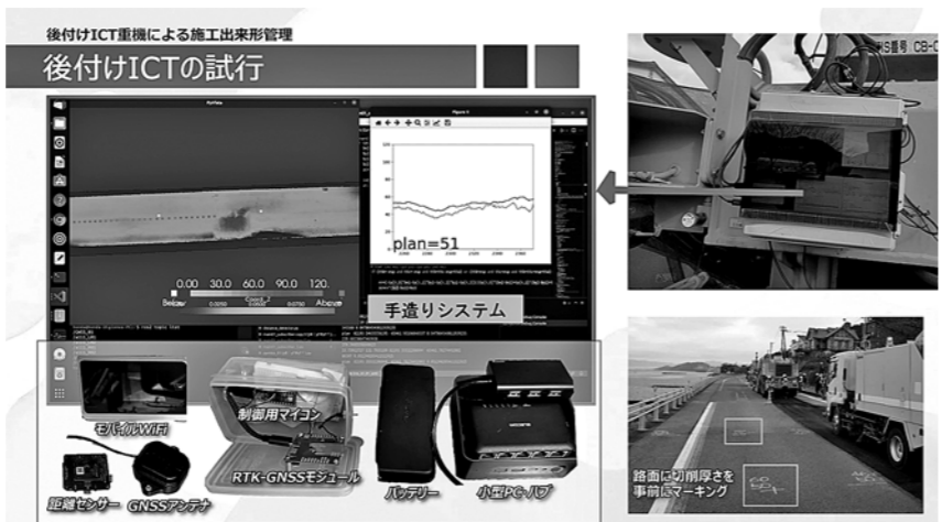
ICT路面切削システムの概要
